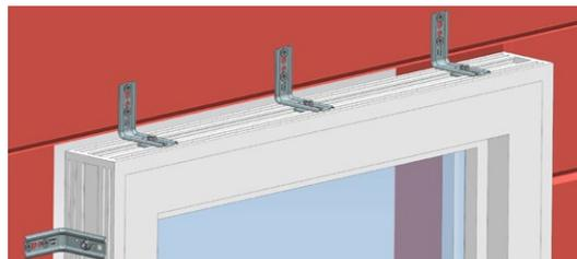
**Remarque :** Le poids de la fenêtre doit être repris sur la traverse basse par des mesures structurales appropriées ou des pattes/équerres appropriées.
